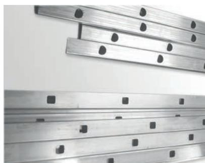
Les montants sont poinçonnés sur les machines avec une très grande précision, afin de permettre l'insertion des barreaux en mode automatique.
