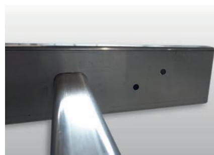
Exemple de poinçonnage à plat sur une diagonale
