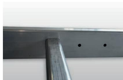
Exemple de poinçonnage à plat dans le plan de symétrie
